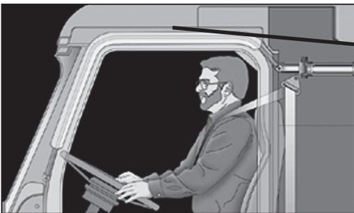
Einschnitt über oder unter den verstaute Airbags und dem Generatorzylinder
