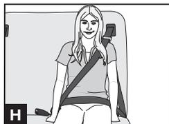
9. Placez le dispositif de réglage de hauteur d'épaule au niveau ou juste au-dessus de l'épaule du passager. La ceinture diagonale ne doit pas reposer sur le visage ou le cou du passager. **I**
