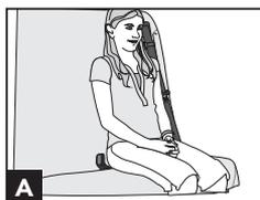
2. Tirez la ceinture diagonale depuis la partie supérieure du dossier de siège. Ne laissez pas la ceinture se tordre. (Il se peut qu'elle se bloque si elle est tirée trop rapidement. Si cela se produit, laissez la ceinture se rétracter légèrement pour la débloquer. Tirez ensuite la ceinture vers vous plus lentement.) **B**
